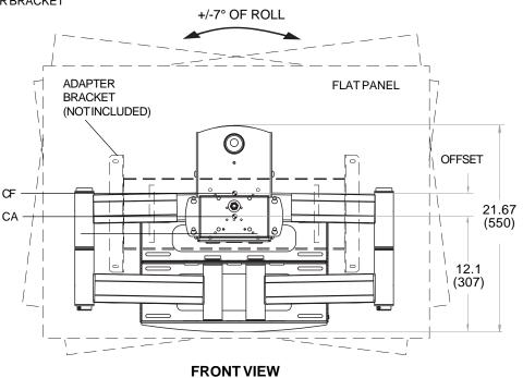
THE MINIMUM FLAT PANEL HEIGHT THAT WOULD FULLY HIDE THE MOUNT IS (12.1"(307 MM) +/- OFFSET\*) X2.
